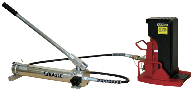
K1-150S ต่อกับปั๊มมือโยกและสายแรงดันสูง
